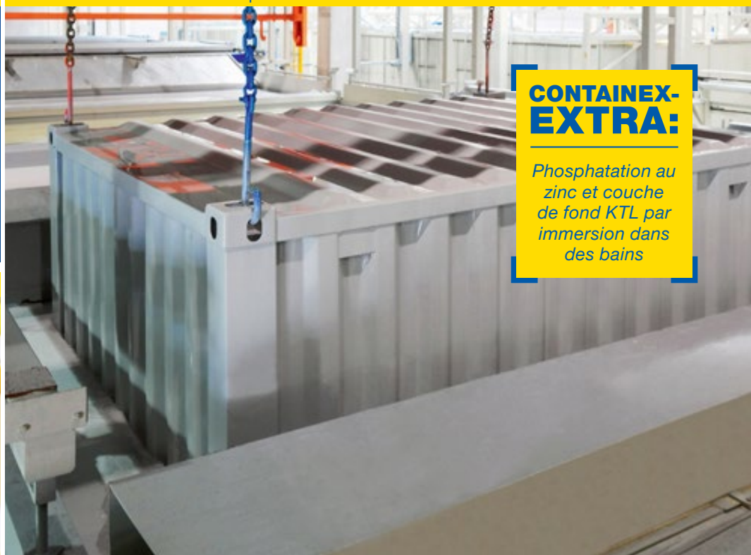
Phosphatation au zinc et couche de fond KTL
